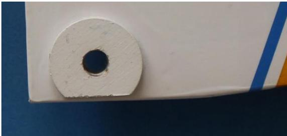
キットに同梱の「主翼取り付け用ボルト座」を、「主翼」の裏側に「主翼取り付け用ボルト」穴と同軸に「低粘度の瞬間接着剤」で取り付けます。
