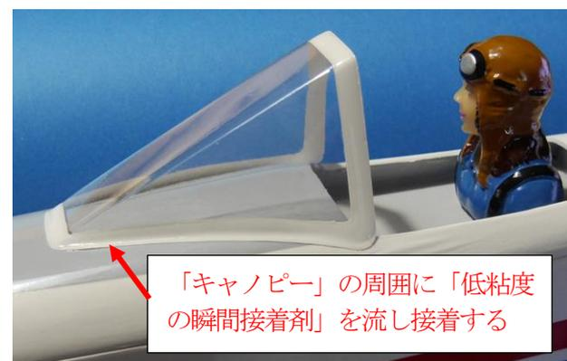
「キャノピー」の「カットライン」に合わせてカットし、周囲に「低粘度の瞬間接着剤」を流し、「硬化促進剤」を使って固定します。
