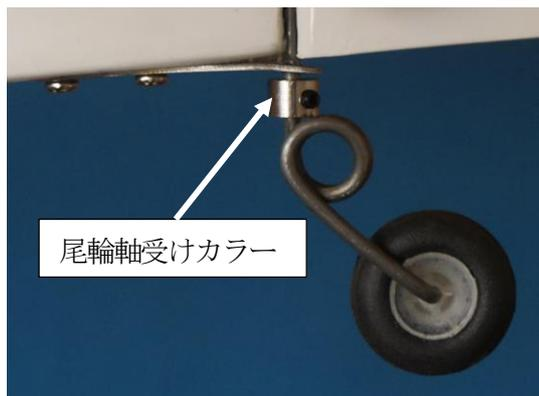
「尾輪軸受けカラー」を「ステー」に軽く当てて、「イモネジ」をしっかり締め付けます。
