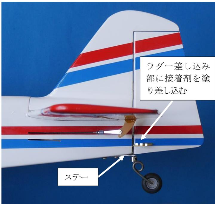
フィルムを剥した「ステー」取り付け部に「30分硬化型エポキシ」を塗り、「ステー」を「φ3×15 タッピングスクリュー」で仮止めします。
