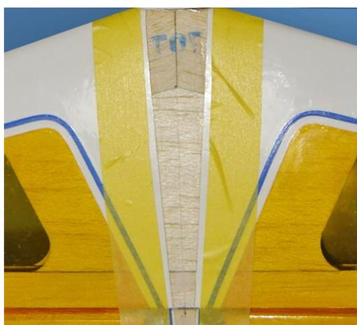
「水平尾翼」上面フィルムの「垂直安定板」を接着する部分をはがし、接着剤のはみ出す部分をマスキングします。
