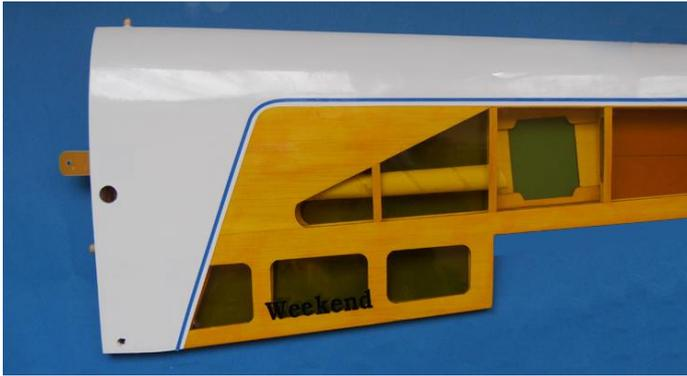
左図を参考に翼の根元より「エルロンサーボ延長コード保護用紙パイプ」を差し込み、長さを合わせた上で、主翼のリブとの間を「30分硬化型エポキシ」で点付けし固定します。
